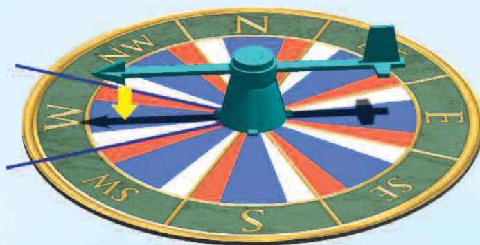
Флюгер вказує, що дме свіжий вітер (синій сектор) на захід (W)
